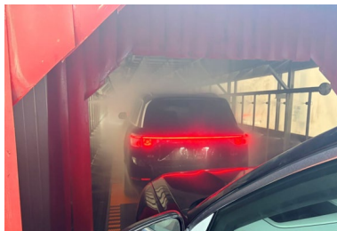
龙兴超级工厂淋雨线
